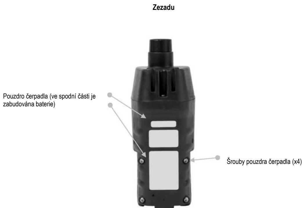
Obrázek 3.1.A Hardware - Přehled: detektor s nasáváním
