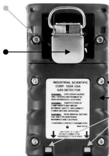
Obrázek 3.1.A Hardware - Přehled: difuzní detektor
